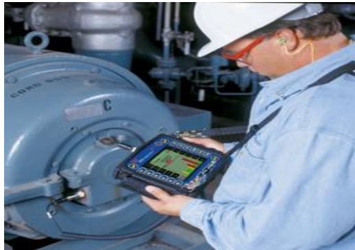
Figura 2.3 Toma de datos con transductor.
