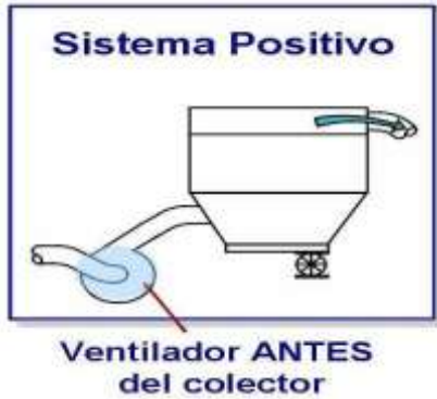
Fig. 10 Sistema de presión positiva
