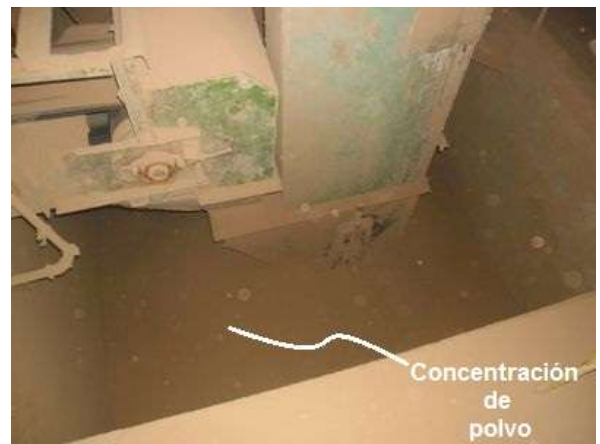
Fig.4 Parte inferior de un elevador de cangilones.
