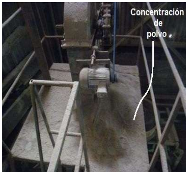
Fig.3 Parte superior de un elevador de cangilones.
