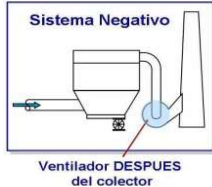
Fig. 11 Sistema de presión negativa
