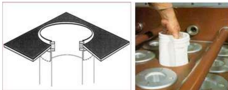
Fig. 17 Fijación de mangas con fleje metálico.
