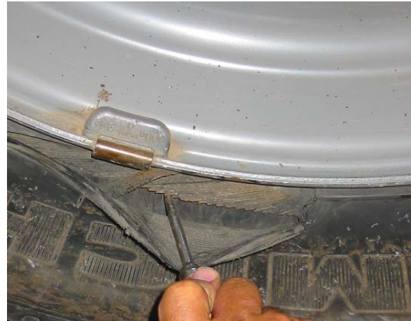
Fig. 10 DESGARRAMIENTO DE LAS CUERDAS
