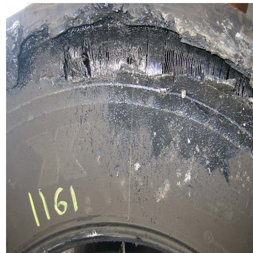
Fig. 4 DESPRENDIMIENTO DE LA CAPA EXTERIOR
