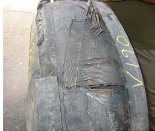
Fig. 14 DESPRENDIMIENTO DE LA CAPA DE RODADURA
