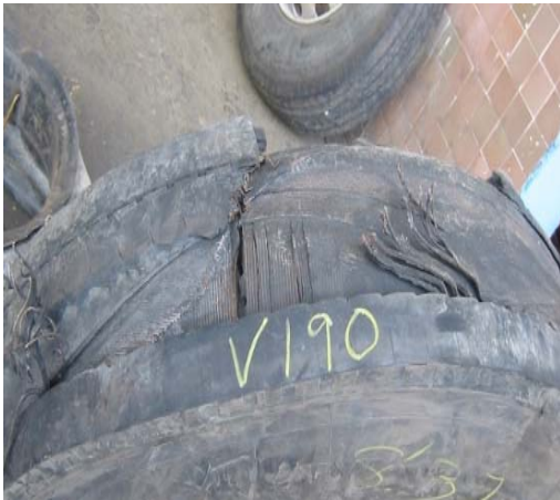
Fig. 15 ROTURA TOTAL POR DESGARRAMIENTO Y DESPRENDIMIENTO
