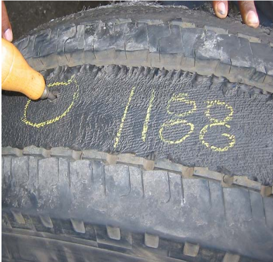
Fig.7 ROTURA POR LA CAPA DE RODADURA
