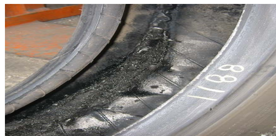
Fig. 6 ROTURAS EN LA CAPA INTERIOR
