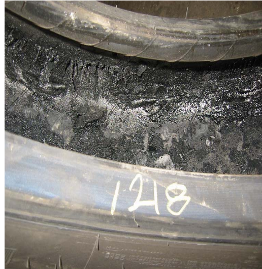
Fig.8 DESPRENDIMIENTO DE LA CAMARA INTERIOR
