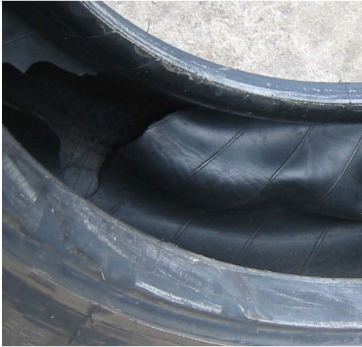
Fig.1 PROBLEMA POR DESPRENDIMIENTO DE LA CAMARA INTERIOR
