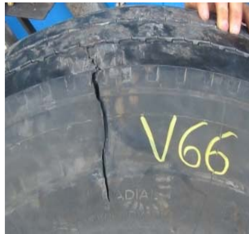
Fig. 16 ROTURA LATERAL POR IMPACTO
