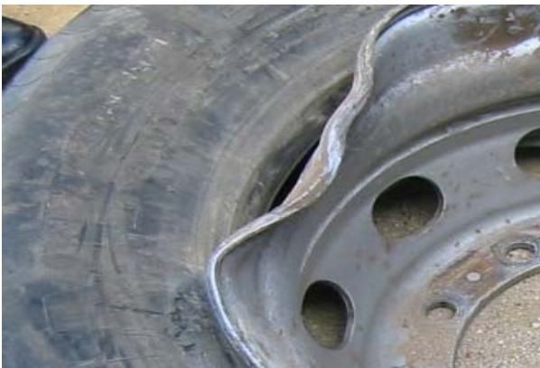
Fig. 11 ROTURA DE LA LLANTA POR IMPACTO
