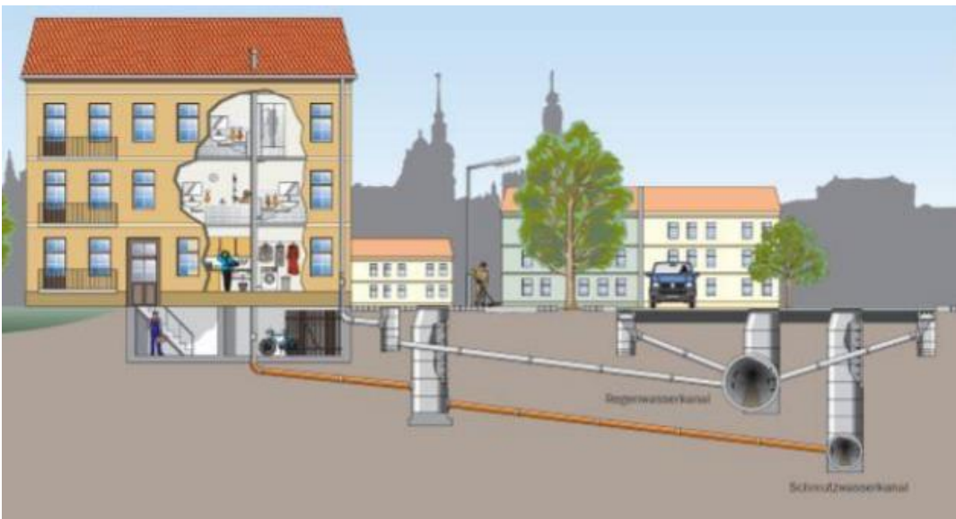
Figura 8. Sistema de alcantarillado separado.
