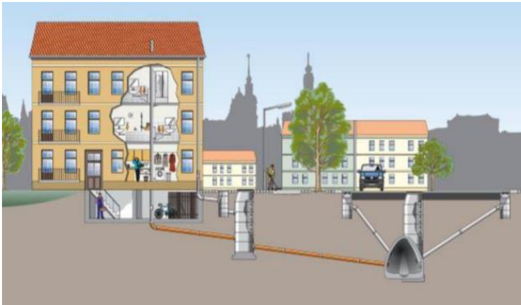
Figura 9. Sistema de alcantarillado combinado.
