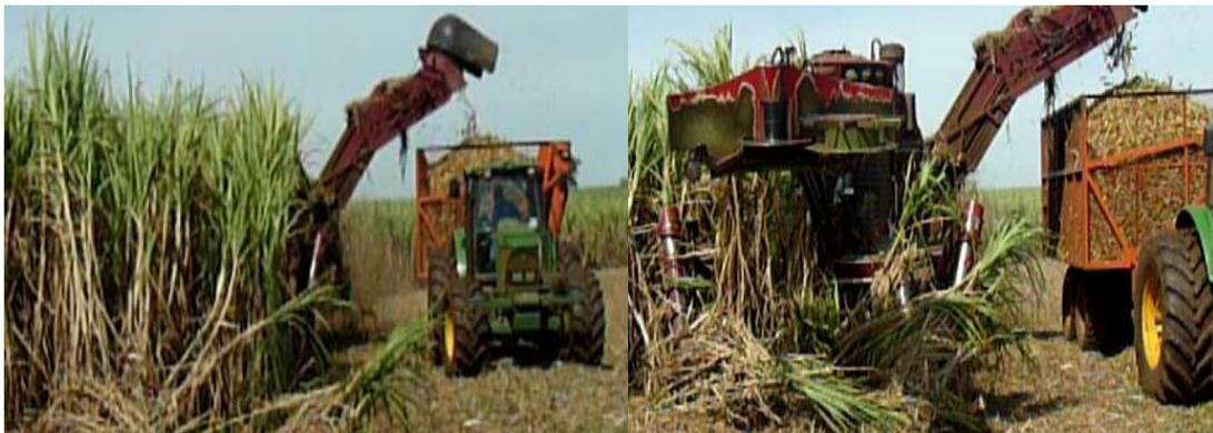
**Figura 6.** Cosechadora CASE A8800, picando tres surcos simultáneamente, con una distancia entre hileras de 0.70 m. **Fuente:** Manual de la CASE A8800.
