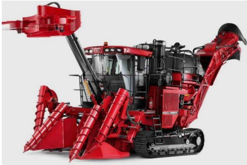
**Figura 5.** Máquina cosechadora cañera CASE A8800. Fuente: CASE, (2014)
