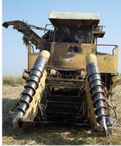
**Figura 3.** Sección Receptora de la Cosechadora de caña KTP-2M. **Fuente:** Fernández, J (2015)
