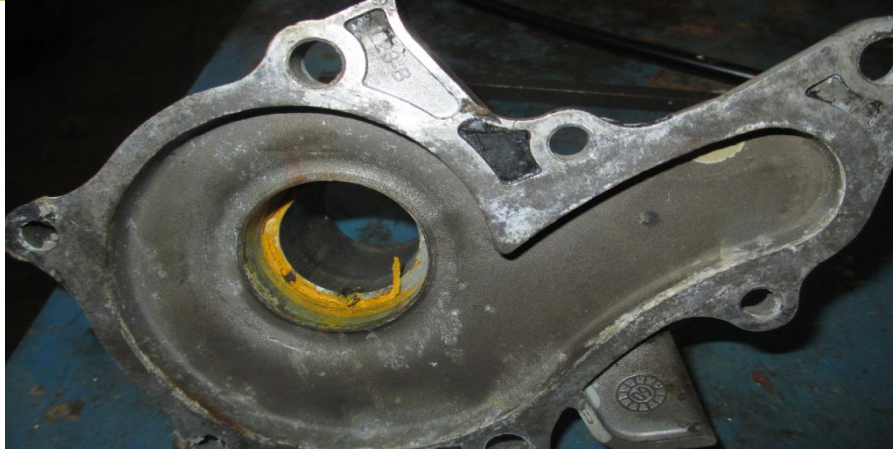
Figura 24. Carcasa de la bomba de agua del Geely, adaptada para el eje del Lada.
