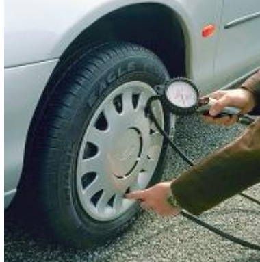
Figura 4. Control de presión de inflado de neumáticos (Fuente Manual Ford)
