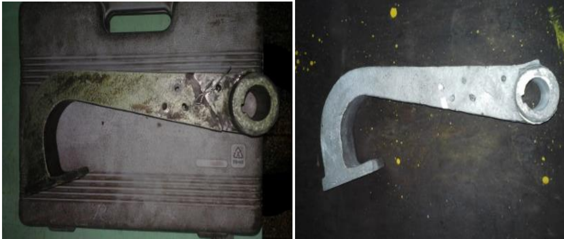
Figura 12. Brazo de la mesa de caída del libro Pony (fabricado de aluminio por fundición).
