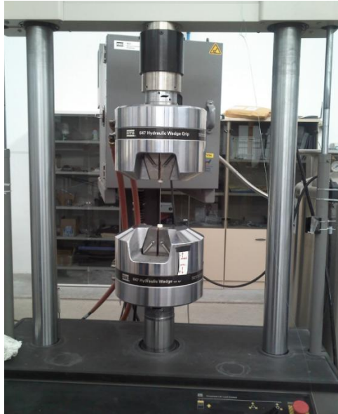
Fig. 1.5. Máquina universal de ensayos MTS 810. (Almaguer, 2014).
