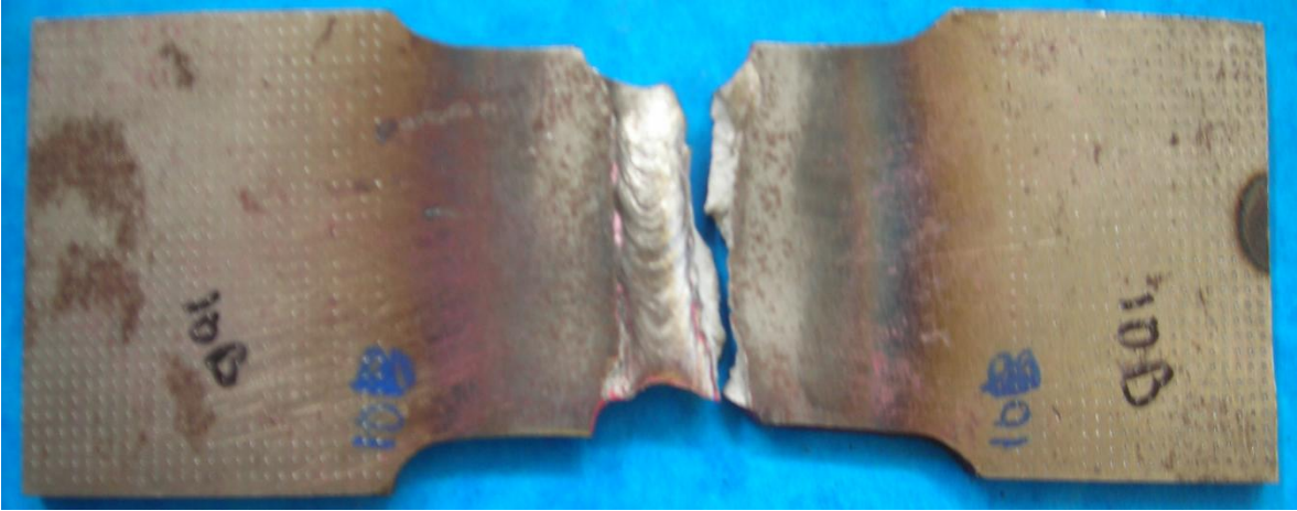
Anexo3. Probeta rota en el ensayo a tracción (Almaguer, 2014).
