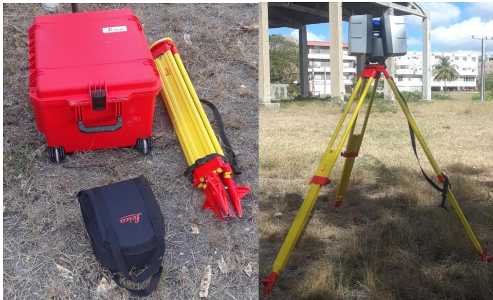
Fig. 2.4. Equipamiento y escáner láser P40 montado sobre trípode.
