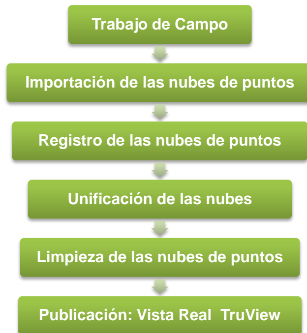
Fig. 2.2. Esquema Tecnológico para el modelado 3D de edificaciones a partir de nubes de puntos generadas por ELT.
