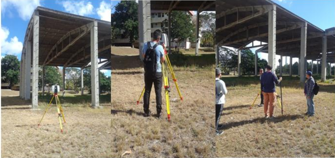
Fig. 2.5. Estacionado #1(Station 1) del escáner y establecimiento de los parámetros con los que se va a trabajar.
