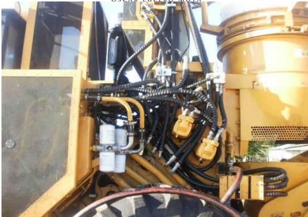
Imagen 3. Distribución de los conductos hidráulicos hasta los órganos de trabajo. Fuente: Tomada por el autor.
