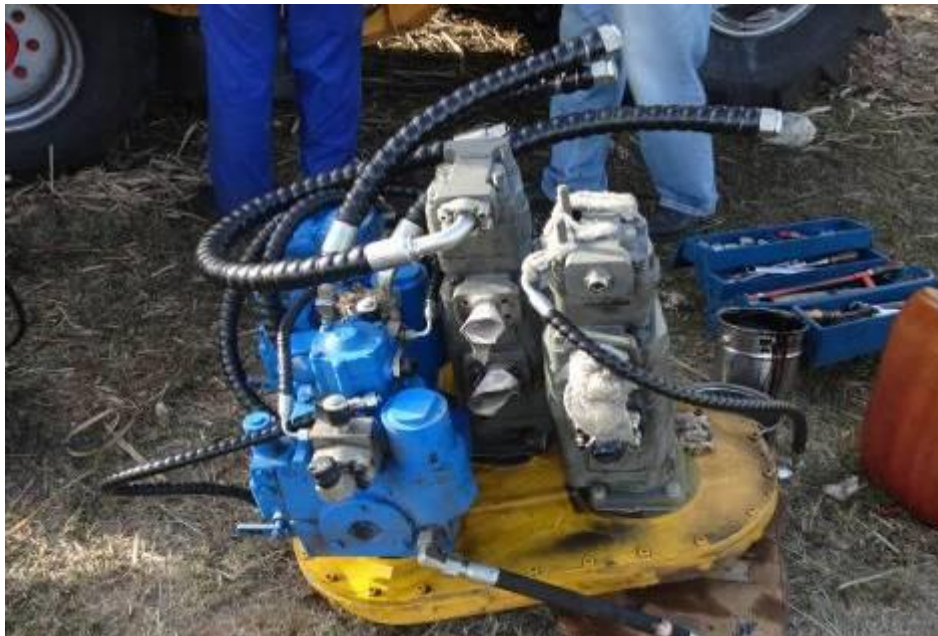
Imagen 2. Caja de bombas desmontada de la instalación del motor. Fuente: Tomada por el autor.
