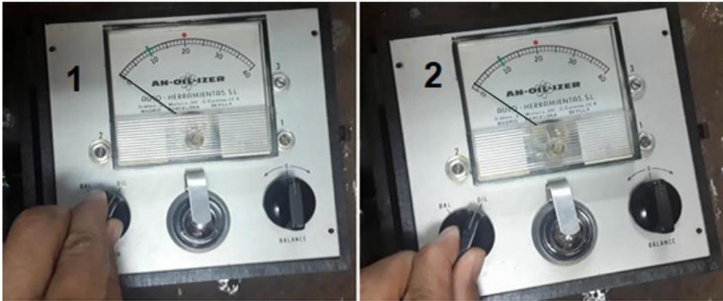
Figura 2.4 Prueba de análisis de la contaminación, aceite nuevo y usado (2).
