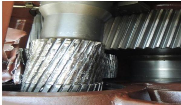
Figura 1.6 Degradación y aplastamiento de engranes de una multiplicadora.
