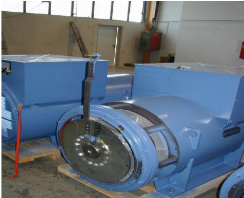
Figura 7. Generador sincrónico Marrelli. Fuente: (MTU, 2006).
