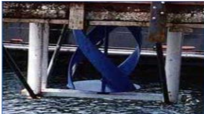
Figura 5. Turbina Helicoidal Gorlov. Fuente: (Girón, 2016)
