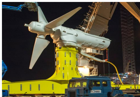
b) Turbina de la fase 1A de 6 MW del proyecto MeyGen
