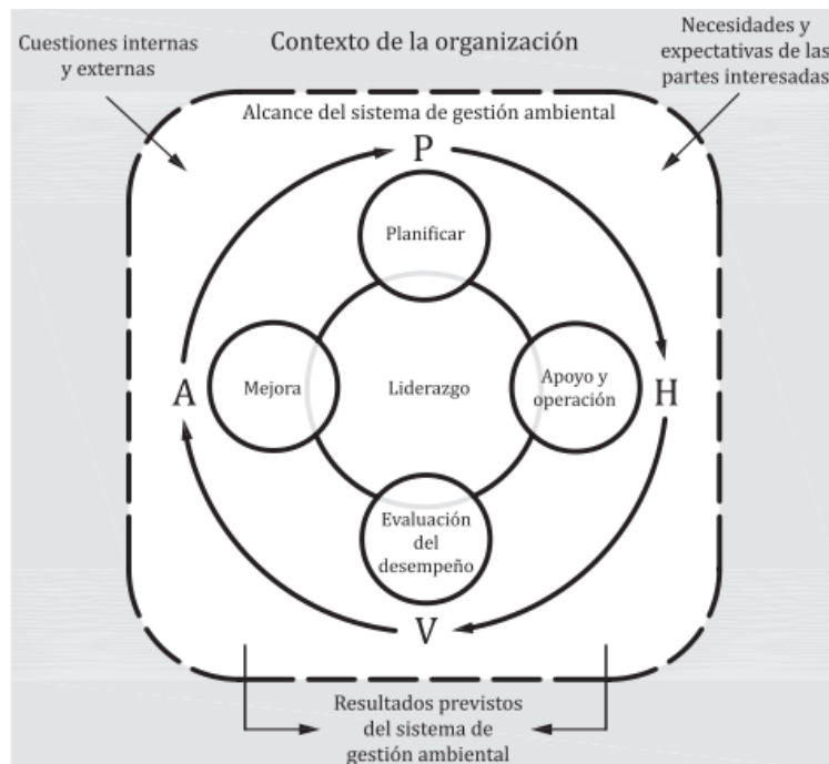
Figura 1.3 Relación entre el modelo PHVA y el marco de referencia en esta Norma Internacional
